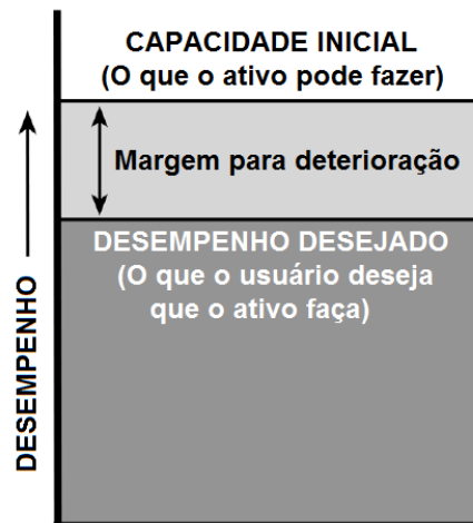
Figura 6 – Margem para deterioração do ativo. Fonte: SAE (2011).
